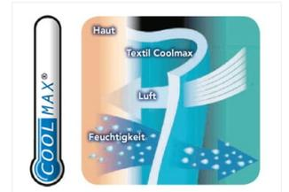
Для того чтобы улучшить способность полиэстера отводить влагу и сделать ткань более мягкой и приятной была разработана специальная нить **Coolmax**. Такая ткань впитывает влагу, выделяемую телом, гораздо быстрее, и сразу переносит ее на наружную поверхность одежды, где она тут же испаряется.
